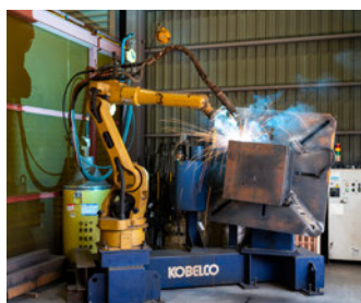
●省スペース型鉄骨コア・仕口兼 用 溶接システム サイズ□200-1000
