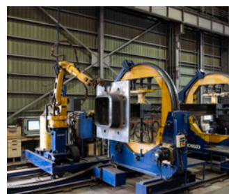
●鉄骨柱大組立溶接ロボットシス テム / 最大重量15t サイズ□250-1000
